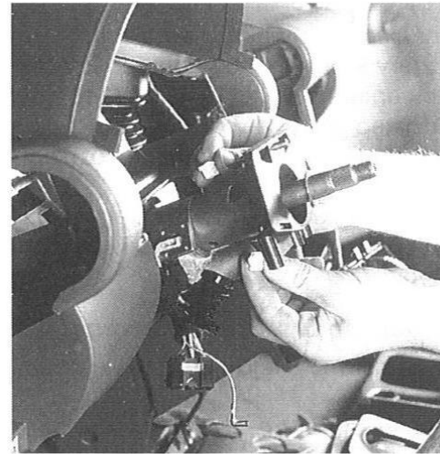
Rys. 11.28. Wymontowanie płytki oprawy przełączników
