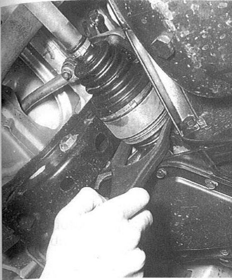
Rys. 6.1. Wymywanie półosi prawej za pomocą przyrządu KM-460-1
