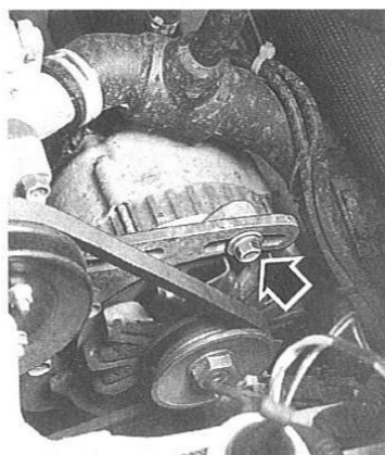
Rys. 11.6. Śruba napinacza paska klinowego napędu alternatora
