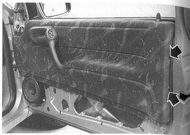
Rys. 12.10. Elementy mocowania pokrycia drzwi przednich
