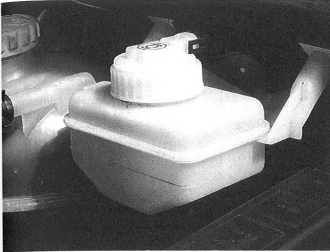
Rys. 0.61. Poziom płynu hamulcowego na zbiorniku
